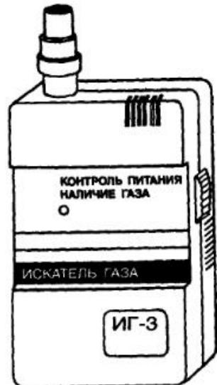
Рис. 161. Портативный искатель газа ИГ-3
