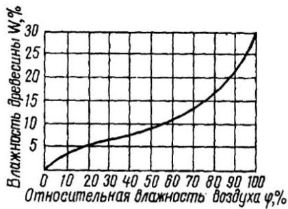
Рис. 29. Изотерма сорбции древесины при комнатной температуре
