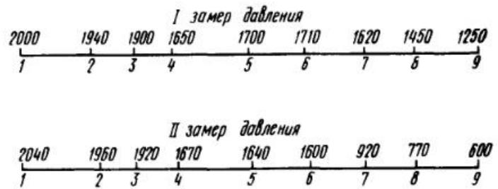
Рис. 48. Результаты измерения давления газа в газопроводе
