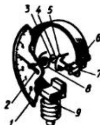
Рис. 82. Манометр с одновитковой трубчатой пружиной:
