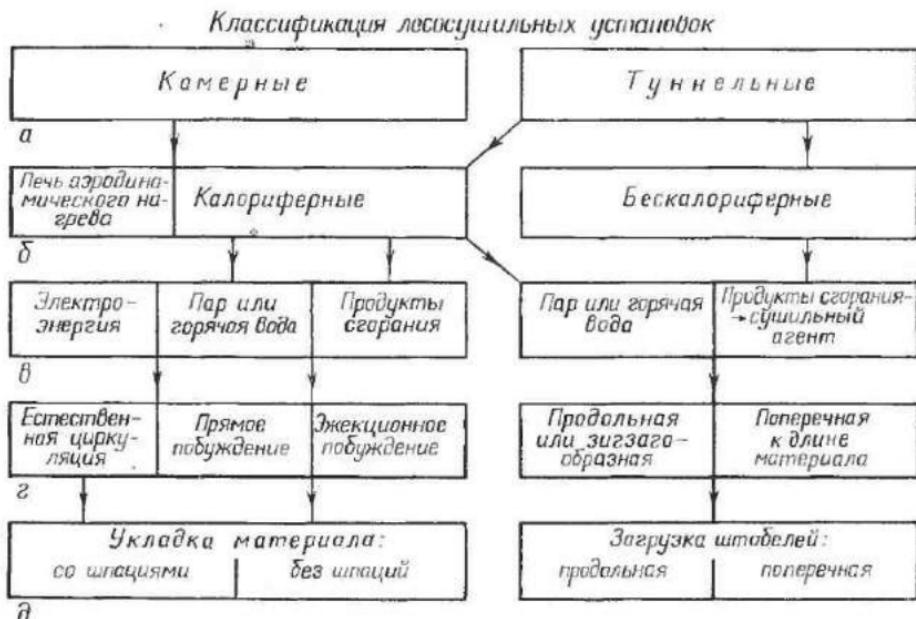
Рис. 89. Классификация лесосушильных установок:
