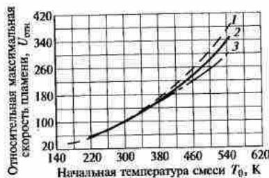
Рис. 12.3. Зависимость скорости пламени от коэффициента избытка топлива при различных начальных температурах смесей для пропановоздушного пламени при атмосферном давлении:
