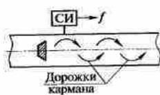
Рис. 8.12. Схема вихревого первичного преобразователя расхода (СИ — устройство счета импульсов)
