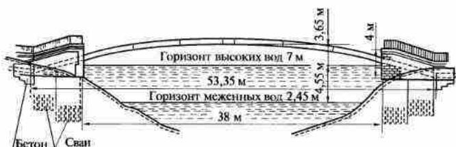
Рис. 4.4. Схема трубчатой арки
